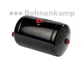
Luftbehälter für Druckluftsysteme 10 Liter, Ø 206 mm, 370 mm lang, schwarz 4 x M22 x 1.5, Betriebsdruck max. 12.5 bar
