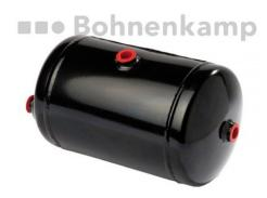
Luftbehälter für Druckluftsysteme 20 Liter, Ø 206 mm, 690 mm lang, schwarz 4 x M22 x 1.5, Betriebsdruck max. 15.5 bar
