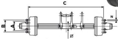
Rückmatikachse 6700/6700/6000 kg bei 40 km/h
